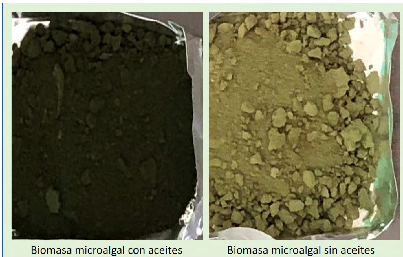
Comparación de biomazas de microalga antes y después de la extracción de ácidos grasos, donde la biomasa residual puede ser aprovechada para obtención de un segundo bioproducto (tomada de trabajo experimental del Laboratorio de Bioenergía, UPSIN).
